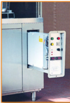
Quadro elettrico estraibile
